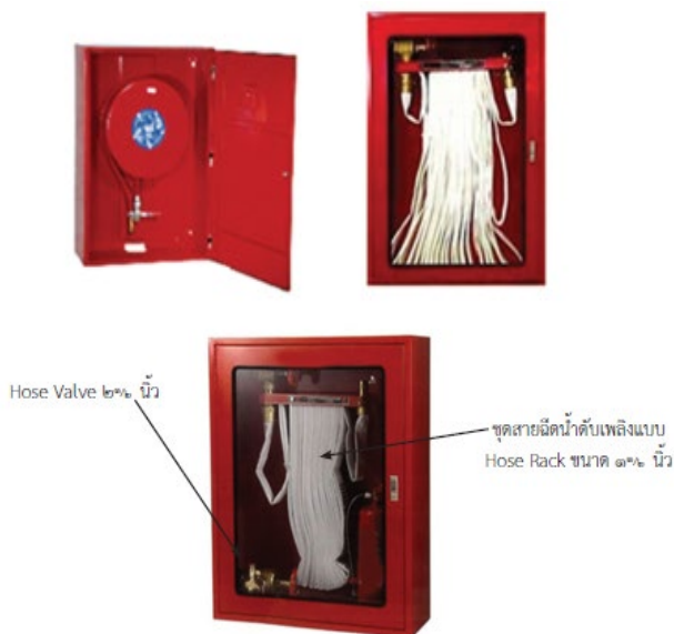
ท่อยืนประเภทที่ 2 : ประกอบด้วยวาล์วสายฉีดน้ำดับเพลิง ขนาด 1 นิ้ว แบบ Hose reel หรือ 1.5 นิ้วแบบ Hose Rack
